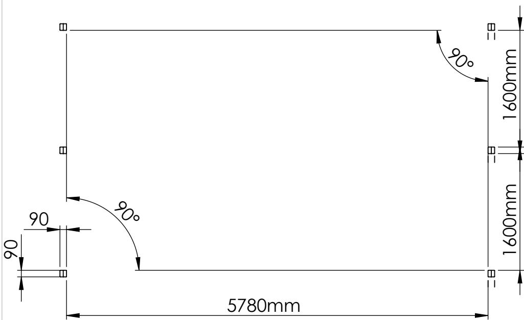
Plot Beton: 400x400x600 mm
